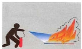
Nel caso di combustibili solidi l'angolo d'impatto deve risultare più accentuato per migliorare la penetrazione della polvere estinguente all'interno delle zone di reazione. In ogni caso si dovrà prestare attenzione perché l'effetto dinamico dell'estinguente potrebbe causare la proiezione di parti calde e infiammate generando la nascita di altri focolai.
